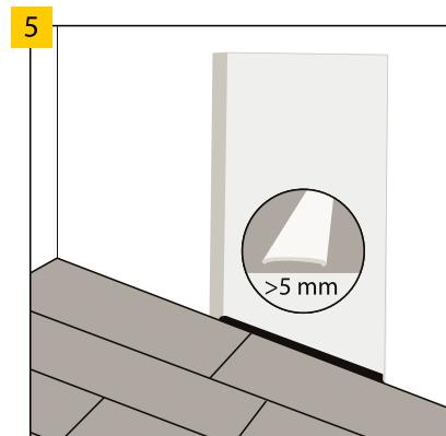
V dverových otvoroch medzi miestnosťami sa odporúča 5 mm dilatačná medzera, aby sa predišlo možným deformáciám v prípade: nepravidelného povrchu podlahy v susedných miestnostiach, umiestnenia ľahkého nábytku v jednej z miestností alebo používania podlahového vykurovania len v jednej zo susedných miestností. Ak je plocha podlahy väčšia ako 200 m<sup>2</sup> alebo dlhšia ako 20 m, dilatačné medzery sa musia zväčšiť na 10 mm.
