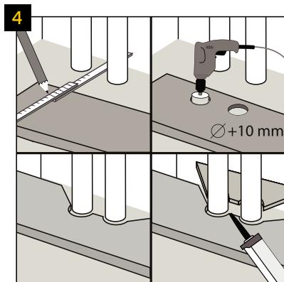
Rovnako postupujte aj pri ďalších vykurovacích rúrkach. Vyrezané prvky panelu treba spojiť pomocou plastového montážneho lepidla.
