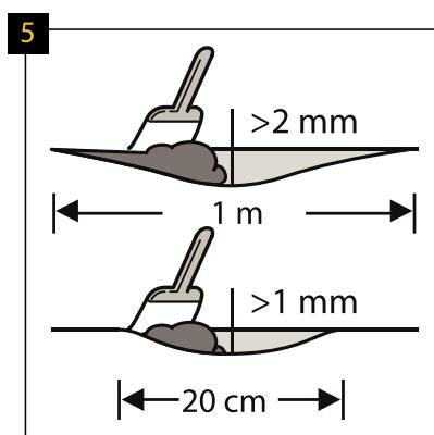
Uistite sa, že je podklad úplne rovný. Všetky nerovnosti podkladu presahujúce 1 mm a dlhšie ako 20 cm, alebo presahujúce 2 mm a dlhšie ako 1 m sa musia vyrovnáť. Skontrolujte, či je potrebné použiť základný náter alebo izolačný materiál. Na prípravu dokonalého podkladu naneste na celý povrch cementovú maltu alebo samonivelačnú hmotu.
