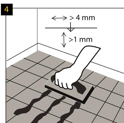
Ak sa robí inštalácia na podklad pokrytý keramickými obkladačkami, vyplňte škáry s medzeračmi širšími ako 4 mm a hlbšími ako 1 mm odolnou výplňou škár, napr. gumovou špárovacou hmotou. Pokladka na dlaždice so špárovacou hmotou nie širšou ako 5 mm a nie hlbšou ako 1 mm je povolená bez použitia vyrovnávacej hmoty, ak sa ako podklad použije Multiprotect Super Hardlay alebo Vinclic Super Solid.
