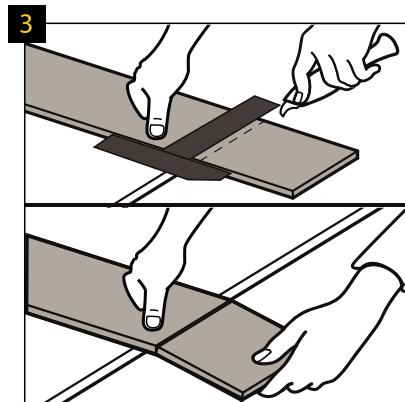
Pri dodatočnom rezaní podlahových panelov odrežte hornú vrstvu nabruseným nožom a rýchlym pohybom odlomte časť panelu a položte ho na okraj. Okrem toho sa podlahové panely dajú ľahko rezať elektrickou pílovou.
