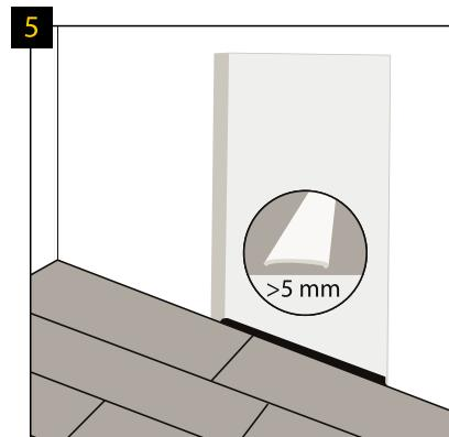
V dverových otvoroch medzi miestnosťami sa odporúča 5 mm dilatačná medzera, aby sa predišlo možným deformáciám v prípade: nepravidelného povrchu podlahy v susedných miestnostiach, umiestnenia ľahkého nábytku v jednej z miestností alebo používania podlahového vykurovania len v jednej zo susedných miestností. Ak je plocha podlahy väčšia ako 200 m<sup>2</sup> alebo dlhšia ako 20 m, dilatačné medzery sa musia zväčšiť na 10 mm.
