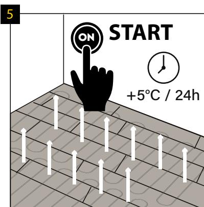
Po 24 hodinách od položenia podlahy je možné zapnúť výkurovanie. Nezabudnite zvyšovať teplotu postupne (o 5 °C denne). PÓZOR! Nezabudnite, že maximálna povrchová teplota podlahy je 27 °C.
