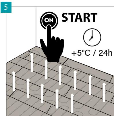
Po 24 hodinách od položenia podlahy je možné zapnúť vykurovanie. Nezabudnite zvyšovať teplotu postupne (o 5 °C denne). PÓZOR! Nezabudnite, že maximálna povrchová teplota podlahy je 27 °C.
